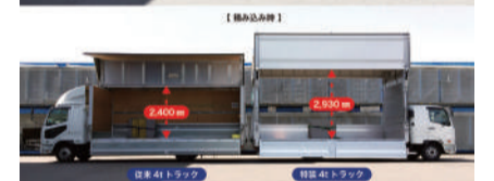
積込作業時は高さ2930mmまで昇降する特装トラック
